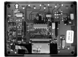
Platine de l'écran tactile TFT
