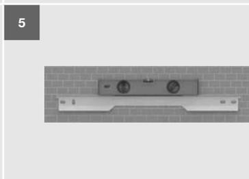
Montez sur le mur le deuxième support de fixation fourni avec l'appareil en vous assurant qu'il soit bien de niveau.
