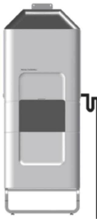
L'installation d'un siphon au niveau des Zehnder ComfoClima 24 et 36 avec 100 mm de garde d'eau est nécessaire.
